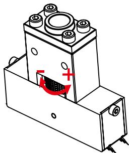
※可通过调节螺母控制针伸出的行程, 在无压缩空气通入的情况下,
